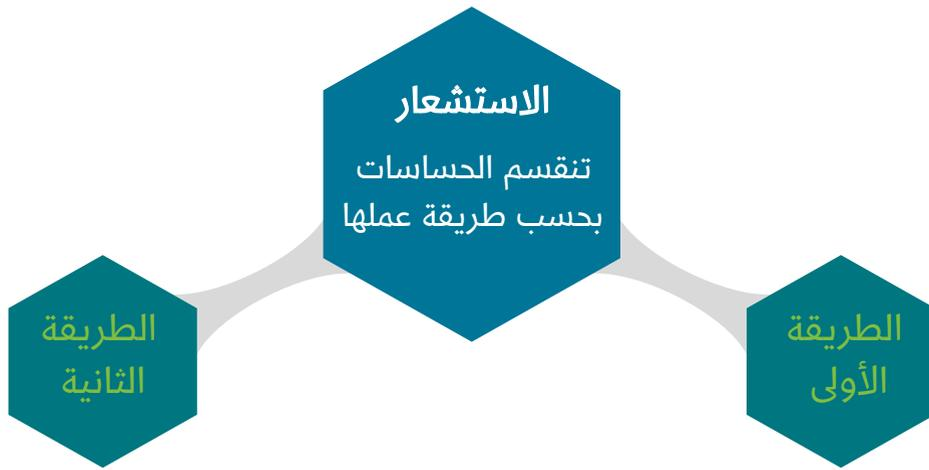
هي كيفية قياس الحساسات للكميات؛ فهي إما أن تكون خاملةً كالكاميرات التي تستقبل الضوء دون الحاجة إلى إرسال الإشارات أو مقاييس الحرارة، وإما أن تكون نشطة بحيث يحتاج الجهاز لإرسال إشارة لقياس الكمية التي يحتاجها.
